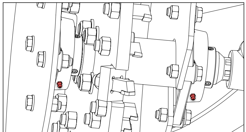
Roulements d'arbre de volant moteur (face inférieure du carter de volant moteur)
